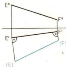
**Konstruktion zur Bestimmung der wahren Größe und Gestalt der Schnittfigur**
