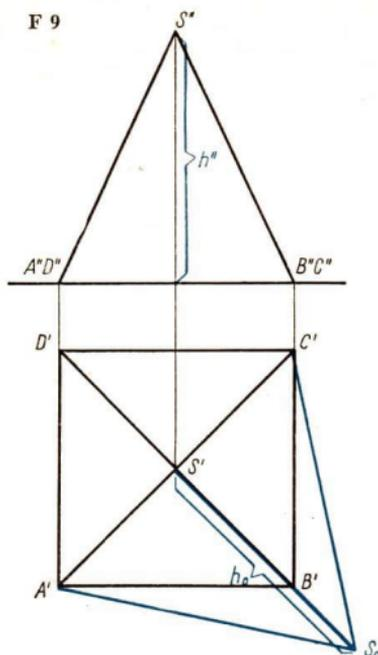
struktion im Grund-Aufriß-Bild zeigt das Bild F 9. Die Strecke  $\overline{A'S_0} = \overline{S_0C'}$  ist gleich der wahren Größe der gesuchten Kante  $\overline{AS}$ .
