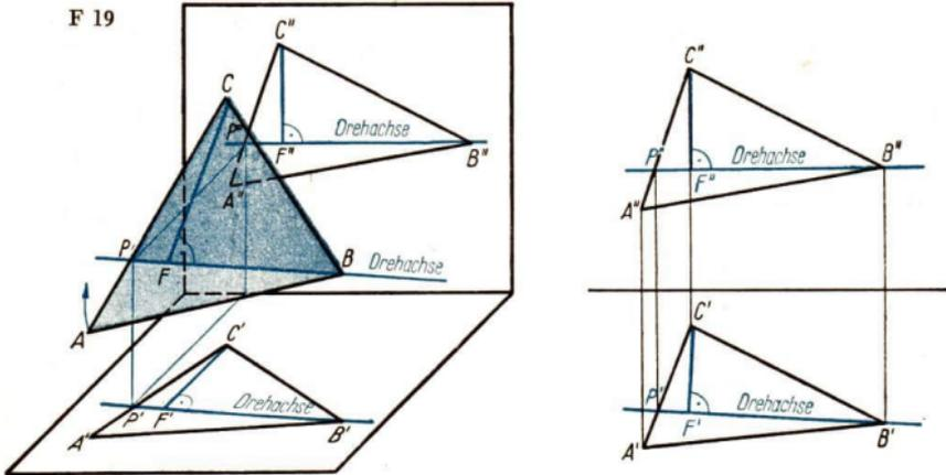
Bei der Drehung bewegen sich alle Punkte des Dreiecks auf Ebenen, die senkrecht zur Drehachse liegen. Wir können also die Lote von jedem Eckpunkt auf die Drehachse eintragen und erhalten damit die Radien der Kreise, die
