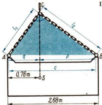
D 25 Welche Länge hat die Kette, wenn der Hakenabstand  $\overline{AB}$  eine Länge von 2,68 m hat und der Abstand des Schwerpunktes  $S$  von der Kastenwand, über der sich der Haken  $A$  befindet, 0,76 m beträgt?
