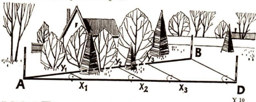
63. Die Strecke  $\overline{AB}$  ist wegen eines Gebüsches nicht absteckbar (Bild Y 10). Man kann aber an dem Gebüsch vorbei die Strecke  $\overline{AD}$  abstecken, wobei  $D$  so gewählt ist, daß  $\overline{BD}$  auf  $\overline{AD}$  senkrecht steht. Das Bild zeigt nun, wie jetzt ein Abstecken möglich ist.
