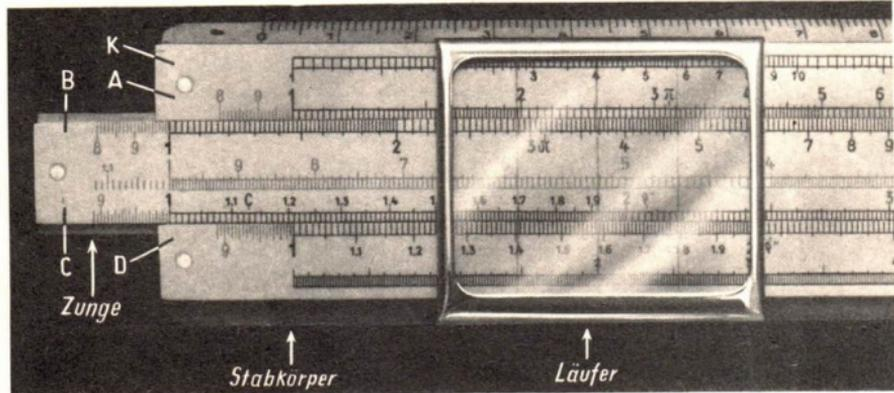
Skale A des Stabes (Bild D 18). Die gesamte Skale A besteht aus zwei gleich langen Abschnitten: der erste umfaßt die Zahlen 1 bis 10, der zweite die Zahlen 10 bis 100.
