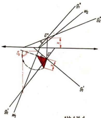
Zur Konstruktion der wahren Größe des Neigungswinkels zweier durch ihre Spuren gegebenen Ebenen  $U (u_1; u_2)$  und  $V (v_1; v_2)$  sind deshalb folgende Konstruktions-schritte erforderlich:
