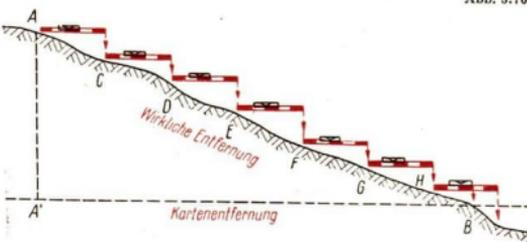
Punkte werden im Gelände meist durch lotrecht aufgestellte Fluchtstäbe (Abb. 3.68.) bezeichnet. Zur Festlegung von Strecken werden zwei oder auch mehrere Fluchtstäbe verwendet. Strecken werden im ebenen Gelände mit Stahlmeßbändern entweder abgesetzt (Abb. 3.69.a) oder fortgesetzt (Abb. 3.69.b) gemessen. Häufig verwendet man
