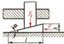
Durch die Reibung wird ein Teil der Kraft nicht genutzt. Der Wirkungsgrad ist der Quotient aus der Anzugskraft ohne Reibung und der Anzugskraft mit Reibung.
