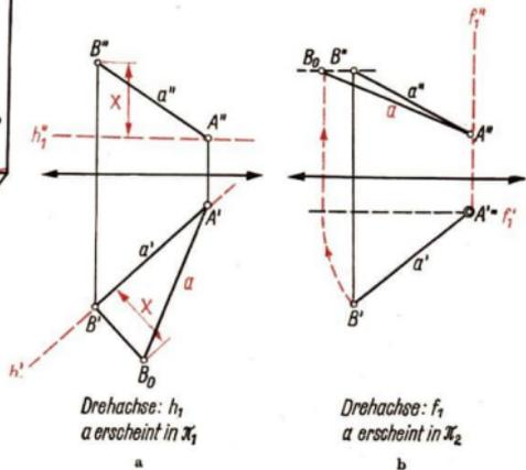
$A$  verlaufende Höhenlinie  $h_1$  für die Drehung in Parallelage zu  $\pi_1$  und die Frontlinie  $f_1$  durch  $A$  für die Drehung in Parallelage zu  $\pi_2$ . Danach ergeben sich die beiden Konstruktionen aus Abbildung 4.32. a und b. Die entsprechenden Konstruktionen für  $V_2$  werden in den Abbildungen 4.33. a und b dargestellt.
