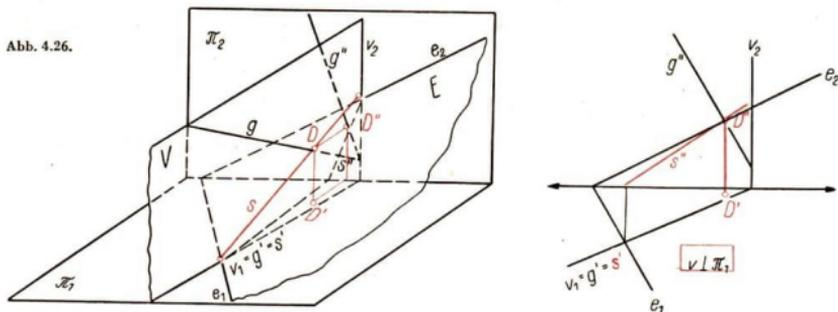
Erläuterung der Konstruktion: Zum Zeichnen der Hilfsebene  $V$  dient **Satz 9**, zur Konstruktion von  $s$  dienen **Satz 12** und **Satz 13**. Bei der hier verwendeten Lage von  $V \perp \pi_1$  entsteht von  $D$  zunächst der Aufriß  $D''$ . Durch die Ordnungslinie ergibt sich dann  $D'$ .
