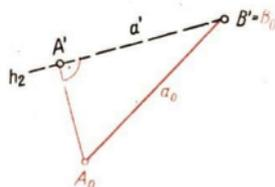
Um die wahre Größe und Gestalt eines Dreiecks zu konstruieren, wird die Ebene des Dreiecks um ihre Spur umgelegt.
