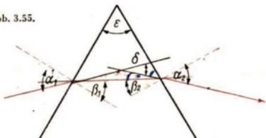
33. Auf ein Glasprisma (Brechzahl  $n = \frac{3}{2}$ ), dessen brechende Flächen einen Winkel  $\epsilon = 60^\circ$  bilden, fällt ein Lichtstrahl unter dem Einfallswinkel  $\alpha_1 = 45^\circ$  ein (Abb. 3.55).
