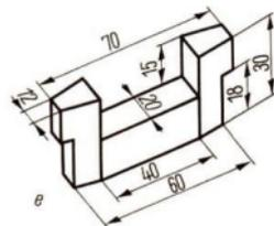
59. Konstruieren Sie die drei Risse eines Stückes
