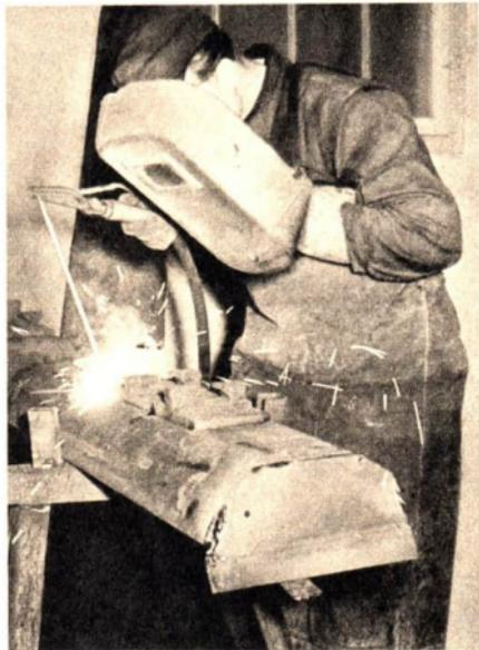
Abb. 99/3. Elektroschweißen
