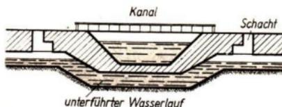
Abb. 58/6. Düker einer Abwässerleitung
