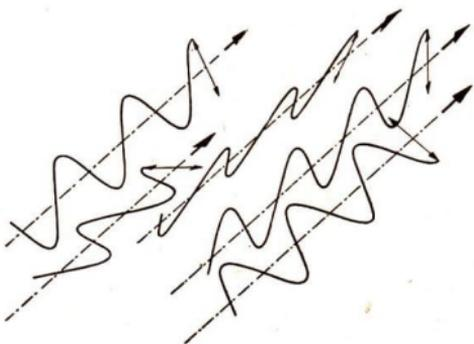
Abb. 95/1. Natürliches Licht (schematische Darstellung). Es besteht aus polarisierten Wellenzügen der verschiedensten Schwingungsrichtungen, von denen keine besonders vorherrscht.
