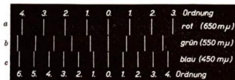
Abb. 74/1. Interferenzstreifen in einfarbigem Licht hinter einem Beugungsgitter.
