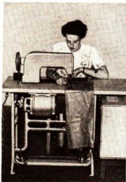
Abb. 24/1. Schweißmaschine zum Herstellen von Schweißnähten bei Igit
