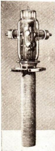
Abb. 41/2. Moderne Senderöhre mit Wasserkühlung. Leistung 100 kW
