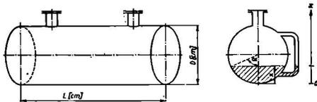
Zum Beobachten der Flüssigkeitshöhe wird ein kommunizierendes Standrohr angebracht. Für einen solchen Lagertank ( $L = 500$  cm,  $D = 200$  cm) soll das Standrohr mit einer Skala versehen werden, die das Ablesen des Flüssigkeitsvolumens in Litern gestattet.
