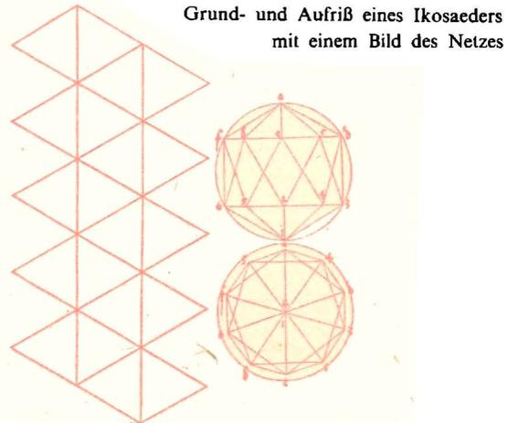
Grund- und Aufriß eines Ikosaeders mit einem Bild des Netzes
