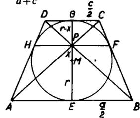
Der Schnittpunkt  $S$  der Geraden  $BC$  und  $AD$  liegt ebenfalls auf der Symmetrieachse  $EG$ . Es sei  $\overline{ES} = h$ ,  $Q$  der Schnittpunkt der Sehnen  $\overline{EG}$  und  $\overline{FH}$  und  $\overline{MQ} = y$ , dann gilt  $\overline{GS} = h-2r$ . Nach dem Strahlensatz erhalten wir  $h:(h-2r) = a:c$  bzw.  $h = \frac{2ar}{a-c}$ . Wenden wir auf das
