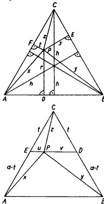
Wir zeichnen eine Parallele zu  $AB$  durch  $P$ , sie schneide  $AC$  in  $E$ ,  $BC$  in  $D$ . Das Dreieck  $EDC$  ist dann ebenfalls gleichseitig.
