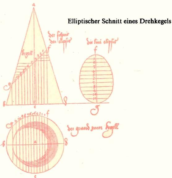
Elliptischer Schnitt eines Drehkegels
