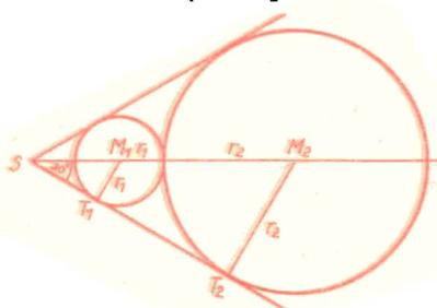
Dann hat das rechtwinklige Dreieck  $M_1ST_1$  die Winkel  $\sphericalangle M_1ST_1 = 30^\circ$  und  $\sphericalangle T_1M_1S = 60^\circ$ ; man kann es sich also durch Zerlegung eines gleichseitigen Dreiecks in zwei kongruente rechtwinklige Teildreiecke entstanden denken. Wegen  $M_1T_1 = r_1$  gilt also  $SM_1 = 2r_1$  und analog  $SN_2 = 2r_2$ .
