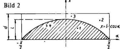
Dabei kann  $x$  alle Werte zwischen 0 und  $d$  annehmen,  $\alpha$  alle Werte zwischen  $-\frac{\pi}{2}$  und  $\frac{\pi}{2}$ . ( $\alpha$  wird zweckmäßigerweise im Bogenmaß gemessen.) In einer mit einem kartesischen Koordinatensystem für die Größen  $\alpha$  und  $x$  versehenen Bildebene nehmen daher die möglichen Lagen der Nadel das in Bild 2 gezeigte Rechteck mit den Seitenlängen  $\pi$  und  $d$  ein. Sein Flächeninhalt  $F_1$  ist gleich  $\pi \cdot d$ .
