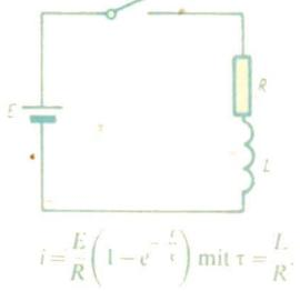
Berechne die Zeit  $t$ , die vom Schließen des Kontakts bis zum Ansprechen des Relais vergeht!
