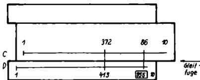
Proportionaleinstellung des Rechenstabs beim Lösen einer Verhältnisgleichung
