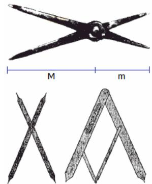
Das einfachste Modell ist der Reduktionszirkel, der aus zwei gleichlangen Stäben besteht, die in dem Punkt, der beide Stäbe im goldenen Schnitt teilt, beweglich aneinander befestigt sind. Ein antiker Vorläufer eines solchen Zirkels wurde z.B. bei den Ausgrabungen in Pompeji gefunden.
