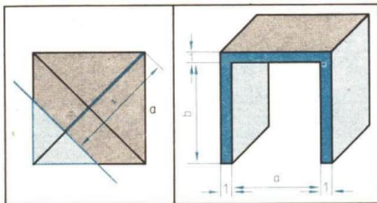
56. Aus drei Holzbrettern von je 20 cm Breite soll eine Wasserrinne von trapezförmigem Querschnitt mit möglichst großem Fassungsvermögen gebaut werden. Geben Sie eine genaue Konstruktionsanweisung!
