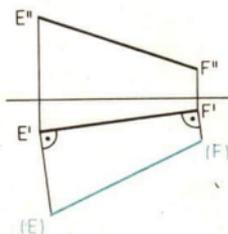
**Konstruktion zur Bestimmung der wahren Größe und Gestalt der Schnittfigur**
