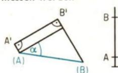
Konstruktion zur Bestimmung des Neigungswinkels  $\beta$  einer Ebene gegen die Bildebene (Stützdreieck) und der wahren Größe und Gestalt einer geneigten ebenen Figur
