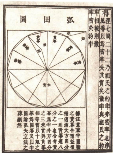
F 36 Chinesische Methode der Kreisberechnung durch Einbeschreiben regulärer Polygone. 3. Jahrhundert u. Z.
