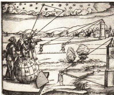
Bild C 19: Verwendung des von dem jüdischen Gelehrten LEVI BEN GURSON (1288–1344) erfundenen sogenannten Jakobsstabes zur Winkelmessung. — Aus dem Titelblatt einer Abhandlung (1533) von P. APIAN
