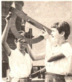
Bild 22/2 Höhenmessung mit dem Pendelquadranten
