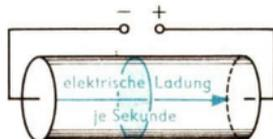
Bild 77/3 Der elektrische Strom ist die Bewegung von elektrischen Ladungen.
