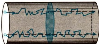
Bild 75/1 Die Richtung der Bewegung und die Geschwindigkeit jedes einzelnen Elektrons werden durch die Zusammenstöße mit den Metall-Ionen mehrfach geändert. Dennoch führt die Gesamtheit der Elektronen im Stromkreis insgesamt eine gerichtete Bewegung aus.
