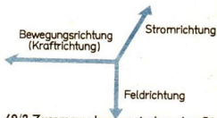
49/2 Zusammenhang zwischen den Richtungen des Stromes, der Feldlinien und Bewegung des Leiterstückes
