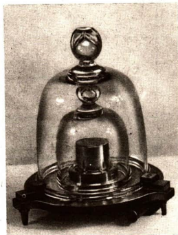
Bild 32/1 Ein Zylinder aus einer Platin-Iridium-Legierung von 39 mm Höhe und 39 mm Durchmesser hat die Masse 1 kg. Er dient als Prototyp, das heißt als Vergleichsmaß für Massenbestimmungen.
