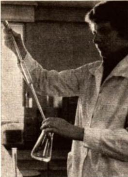
110/1 Pipette zum Entnehmen von Flüssigkeitsproben
