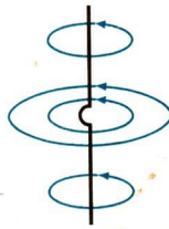
Bild 81/4 Magnetisches Feld in der Umgebung eines Dipols zum Zeitpunkt größter Stromstärke
