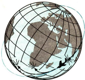
Bild 13/1 Wenn ein Geschöß eine genügend große Geschwindigkeit hätte, müßte es auf einer Kreisbahn um die Erde fliegen.
