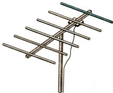
Bild 78/1 Fernsehempfangsantenne mit stabförmigem Reflektor
