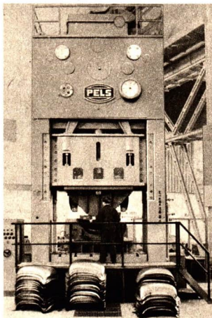
Abb. 49/1. Presse zum Formen von Karosserieteilen
