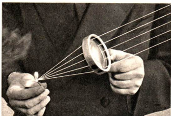
Abb. 170/1. Entzünden eines Streichholzes mit Hilfe einer Sammellinse. Die im Bild sichtbaren Lichtstrahlen sind nachträglich eingezeichnet.
