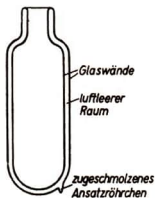
Abb. 118/1. Glasgefäß der Thermosflasche
