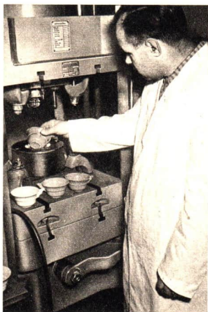
Abb. 50/1. Pressen von Tassen aus Plast
