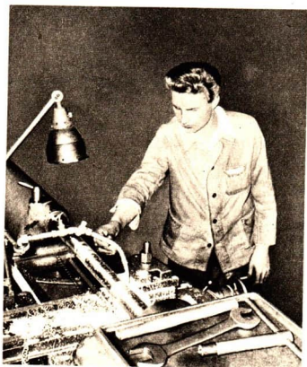
Abb. 90/1. Kühlung beim Drehen
