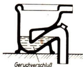
Abb. 58/2 Geruchverschluß am Wasserklosett im Schnitt
