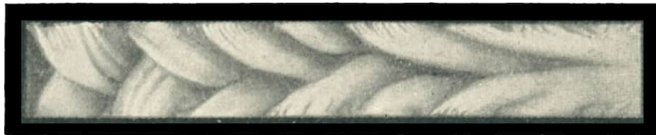
Abb. 8/1. Das Bild einer Funkenentladung im Drehspiegel
