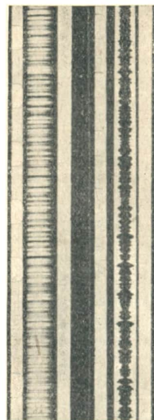
a b Abb. 109/1. Tonspur auf einem Tonfilmstreifen a) Sprossenschrift b) Zackenschrift
