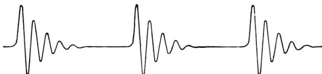
Abb. 8/3 Wiederholte Entladung in gedämpften Schwingungen
