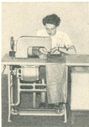
Abb. 24/1. Schweißmaschine zum Herstellen von Schweißnähten bei Igelit
