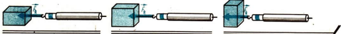
Bild 20/4 Die Reibungskraft hängt beim gleichen Körper nicht vom Flächeninhalt der Berührungsfläche ab
