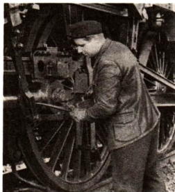
Bild 23/2 Alle Maschinen, bei denen gleitende Teile vorhanden sind, müssen abgeschmiert werden. Dadurch wird die notwendige Antriebsenergie verringert, und der Verschleiß wird herabgesetzt. Bei der Erfüllung unserer Volkswirtschaftspläne kann deshalb jeder auch durch sorgfältige Maschinenwartung mithelfen. Viele Arbeiter haben schon die von ihnen benutzten Maschinen in persönliche Pflege genommen
