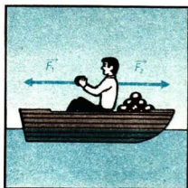
Bild 128/3 Fortbewegung durch Rückstoßkräfte
