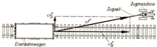
Abb. 136/2. Kraftzerlegung bei einer Bewegung auf einer vorgeschriebenen Bahn
