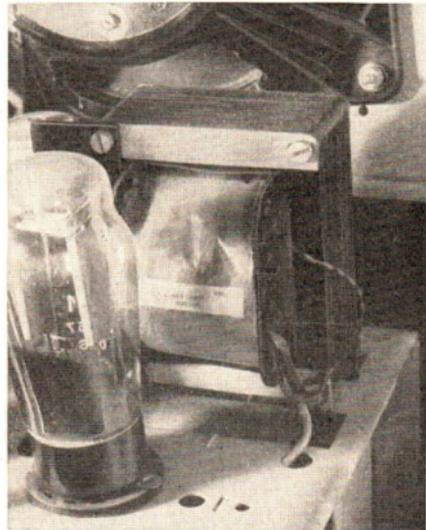
Abb. 107/3. Netztransformator
