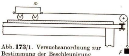
Abb. 173/1. Versuchsanordnung zur Bestimmung der Beschleunigung
