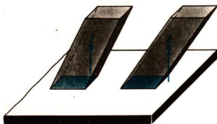
Bild 135/2 Ein Körper kippt um, wenn die Schwerlinie nicht mehr durch die Unterstützungsfläche geht
