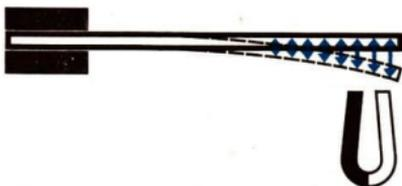
Bild 116/1 Statische Kraftwirkung eines Magneten
