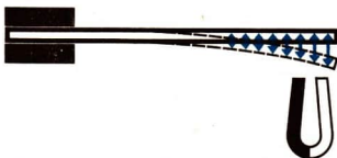
Bild 116/1 Statische Kraftwirkung eines Magneten
