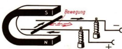
Ein stromdurchflossener Leiter in einem Magnetfeld bewegt sich. Die mechanische Bewegungsenergie entsteht aus elektrischer Energie durch die Wechselwirkung der beiden Magnetfelder.
