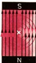
Durch die Feldüberlagerung entsteht auf der einen Seite des Leiters (im Bild links) ein stärkeres Magnetfeld als auf der anderen.
