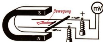
Bewegt man einen Leiter in einem Magnetfeld, so entsteht eine Induktionsspannung. Es muß mechanische Energie aufgewendet werden, um die elektrische Energie zu erhalten.
