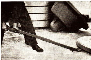
Abb. 59. Verwendung einer Brechstange zum Anheben eines schweren Gegenstandes
