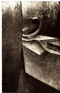
Abb. 86. Spanabhebung bei der Bearbeitung eines Werkstückes auf einer Drehbank
