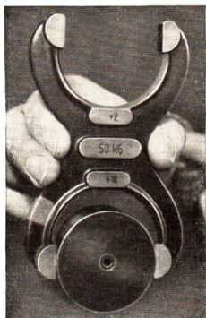
Abb. 11. Rachenlehre zum Überprüfen des Durchmessers zylinderförmiger Werkstücke
