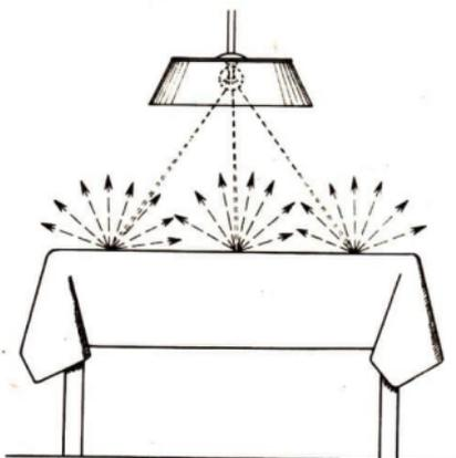
Abb. 166 Unregelmäßige Zurückwerfung des Lichtes durch das Tischtuch
