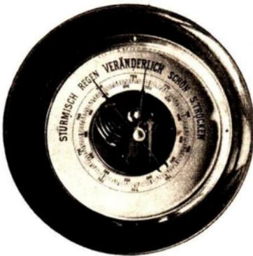
Abb. 85 Dosenbarometer
