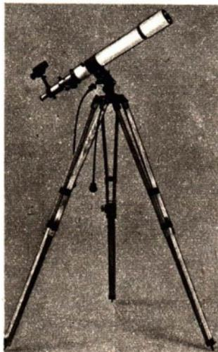
Abb. 206 Himmelsfernrohr (Reisefernrohr) aus dem volkseigenen Betrieb Carl Zeiss, Jena. Objektiv  $\varnothing = 6$  cm, Objektiv-Brennweite = 0,84 m, Feldstecher  $6 \times 30$  als Sucher
