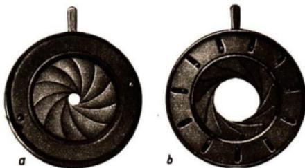
Abb. 186 Irisblende. a kleine, b große Blendenöffnung
