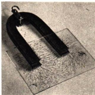
Abb. 225 Die magnetischen Feldlinien eines Hufeisenmagneten
