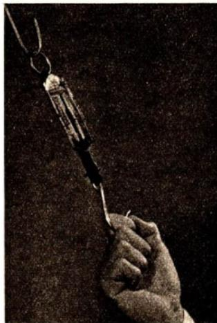
Abb. 47 Mit der Federwaage messen wir Muskelkräfte.
