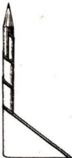
Abb. 128 Wie die Schraubenslinie entsteht
