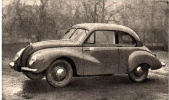
Abb. 325 Der neue DKW-Frontantriebswagen DKW-F-9-Innenlenker, Viersitzer. 28-PS-Dreizylinder-Zweitaktmotor, Frontantrieb, Freilauf, Doppelprofilrohrrahmen, Radstand 2350 mm. Der Wagen wird von den volkseigenen Deutschen Kraftfahrzeug-Werken (DKW) in Griefbach (Sachsen) gebaut.
