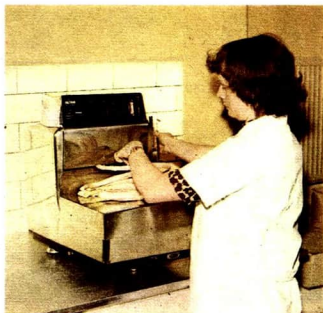
Bild 42/1 Moderne Waage für Lebensmittel (Meßbereich bis 3 kg)
