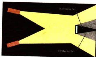
Bild 112/2 Experimentieranordnung mit zwei Heftleuchten
