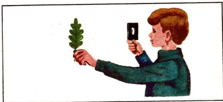
Bild 141/1 Betrachten eines Gegenstandes durch eine Sammellinse. Der Gegenstand befindet sich innerhalb der einfachen Brennweite der Linse.
