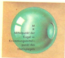
Bild 120/2 Hohlspiegel als Teil einer Kugel
