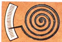
Bild 74/3 Verwendung des Bimetallstreifens zur Temperaturmessung
