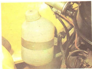
Bild 77/1 Ausdehnungsgefäß für das Kühlmittel beim PKW Wartburg 353
