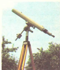
Bild 153/3 Astronomisches oder Keplersches Fernrohr
