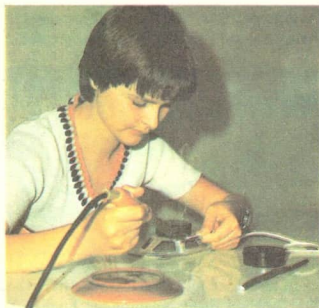
Bild 59/2 Ausnutzen der Adhäsionskräfte beim Lötén
