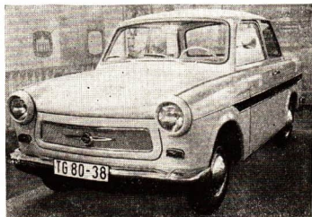
48/1 Bei dem Personenkraftwagen „Trabant 601“ des VEB Automobilwerk Sachsenring Zwickau, besteht die Karosserie aus Plast. Aus Plast sind auch manche Eimer, Steckdosengehäuse und Schalter
