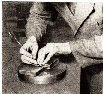
44/1 Beim Anreißen nutzt man die unterschiedliche Härte der Stoffe aus
