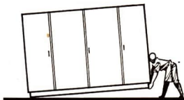
Bild 32/2 Das Heben durch direktes Anfasen an der Unterkante des Schrankes erfordert viel Kraft
