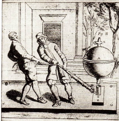
Bild 110/1 Originalabbildungen aus Guericke's „Experimenta Nova“ (Neues Experiment) links: Auspumpen einer Kupferkugel, rechts: Luftpumpe
