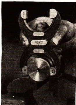
Abb. 14/1. Gebrauch einer Rachenlehre beim Prüfen eines Werkstückes
