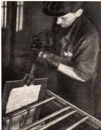
Abb. 109/1. Herausnahme einer galvanisch überzogenen Matrize aus dem Galvanisierungstrog
