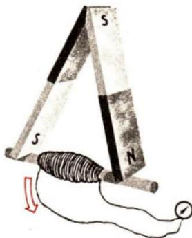
39/1 Induktionsversuch Faradays
