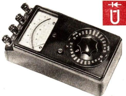
59/2 Das Vielfach-Meßgerät des VEB Gerätewerk Karl-Marx-Stadt hat ein Drehspulmeßwerk. Für Wechselstrommessungen wird ein Gleichrichter vorgeschaltet
