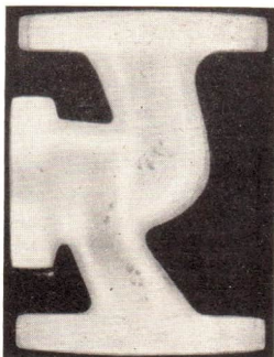
186/2 Aufnahme eines Ventilgehäuses unter Verwendung von \gamma -Strahlen
