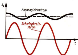
18/1 Der Anodengleichstrom pulsiert im Rhythmus des Schwingkreisstromes
