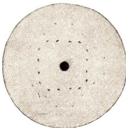
113/2 Beugung von Röntgenwellen beim Durchgang durch einen Kristall (Laue-Diagramm). Man nennt dieses Beugungsbild ein Laue-Diagramm . Es gibt einerseits Aufschluß über das Wesen der Röntgenwellen und andererseits über die Struktur des durchstrahlten Kristalls
