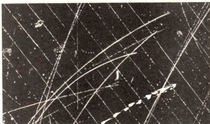
Bild 25/4 Nebelkammeraufnahme von Protonen, die aus wasserstoffhaltigem Gas durch auftreffende Neutronen ausgestoßen wurden. Man erkennt, daß die selbst nicht sichtbaren Neutronen von rechts oben in die in einem Magnetfeld stehende Nebelkammer eingefallen sind
