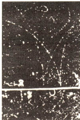
Bild 21/2 Nebelkammeraufnahme der Teilchenspuren eines Elektrons und eines Positrons. Die Spur des Positrons verläuft nach rechts, die des Elektrons nach links. Die Nebelkammer befand sich in einem starken Magnetfeld
