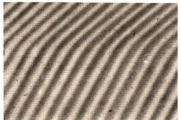
Bild 106/3 Brechung von Wasserwellen in der Wellenwanne
