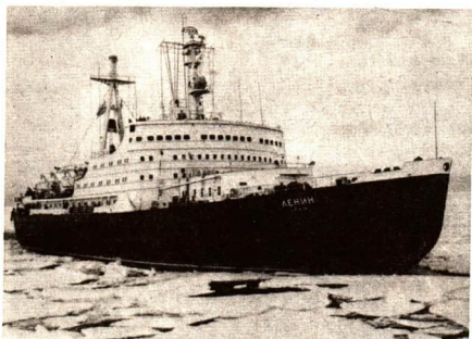
Bild 42/1 Der Atomeisbrecher „Lenin“ ist mit drei Druckwasserreaktoren ausgestattet und arbeitet mit Uran als Brennstoff
