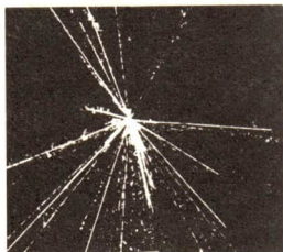
Bild 25/1 Fotoplatte mit Elementarteilchenspuren, die durch die Neutralisierung der Silberatome entstanden sind
