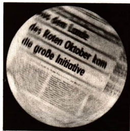
Bild 52/1 Auf eine Scheibe wird ein bedrucktes Blatt Papier geklebt. Bei Rotation kann man die Buchstaben in der Nähe der Drehachse noch erkennen, während sie weiter außen wegen der größeren Bahngeschwindigkeit verschwimmen.
