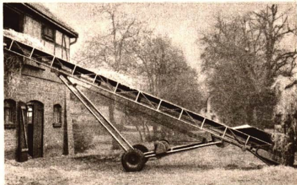
Bild 21/2 Der Bandförderer kann zum Transport von Strohballen benutzt werden. Der Strohballen bewegt sich dabei geradlinig
