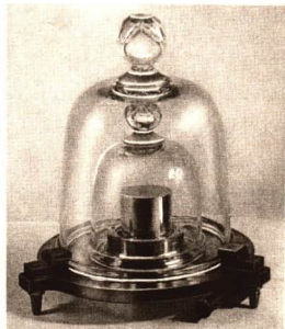
Bild 34/2 Zylinder aus Platin-Iridium mit der Masse 1 kg. Die Glasglocken schützen ihn vor Feuchtigkeit
