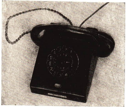
Abb. 212/1. Telefonapparat. Der abnehmbare Handapparat enthält das Mikrofon und das Telefon.
