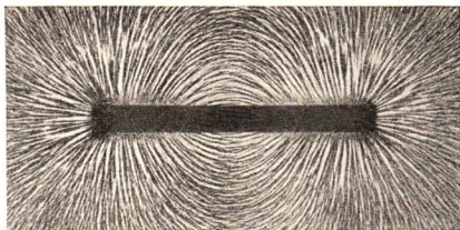
Abb. 195/1. Feldlinienbild eines Stabmagneten
