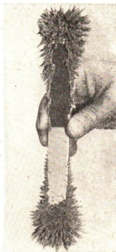
Abb. 195/3. Eisenfeilspäne an einem Stabmagneten
