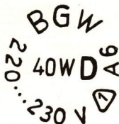
Abb. 178/3. Leistungsschild einer Glühlampe. Es enthält außer der Leistung und der Spannung auch den Herstellerbetrieb (BGW = Berliner Glühlampenwerk), das Herstellungsjahr ( \delta = 1956), den Herstellungsmonat ( A = Januar) und die Wendelung ( D = Doppelwendel).
