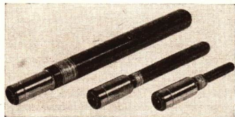
Abb. 212/1. Zählrohre, hergestellt im VEB Vaku- tronik Dresden
