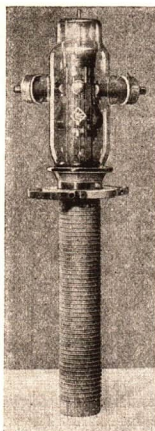
Abb. 124/1 Moderne Senderöhre mit Wasserkühlung
