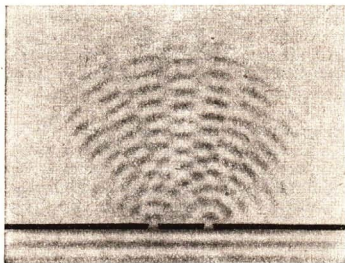
Abb. 82/3 Interferenz hinter einem Hindernis mit Doppelspalt
