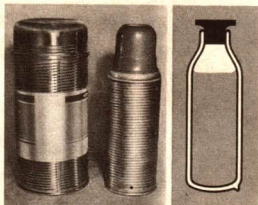
Bild 16/2 Thermosgefäße. Der fast luftleer gepumpte Raum zwischen den Gefäßwänden isoliert noch besser als ein Luftmantel. Durch Verspiegeln der Innen- und Außenwänden wird auch der Einfluß der Wärmestrahlung gering gehalten. Was weißt du über die Wärmeleitfähigkeit von Glas?
