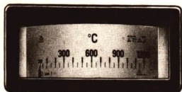
Bild 79/2 In Grad Celsius geteilte Skale eines Strommessers. Beim Widerstandsthermometer fließt durch eine Wendel (z. B. aus Platin) Strom. Ändert sich die Temperatur, so ändert sich der Widerstand der Wendel. Ein Erhöhen der Temperatur hat ein Vergrößern des Widerstandes zur Folge; die Stromstärke nimmt ab. Das Meßgerät ist mit einer Teilung in Grad Celsius ( ^{\circ}\text{C} ) versehen
