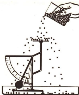
Bild 21/1 Modellversuch zum Gasdruck. Durch die Stöße der herabfallenden Schrotkugeln zeigt die Waage einen etwa gleichbleibenden Ausschlag
