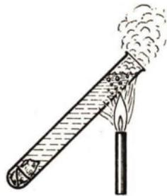
Abb. 93. Wasser ist ein schlechter Wärmeleiter. Am Boden des Röhrchens liegt ein Eisstückchen, während das Wasser im oberen Teil des Glases siedet.
