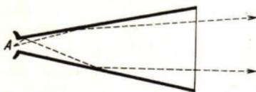
Abb. 111. Sprachrohr (bei A der Mund des Rufers). Die gestrichelten Linien deuten die Ausbreitung des Schalles an.
