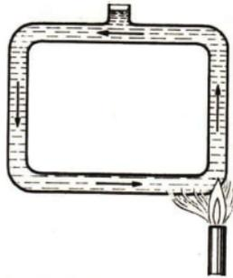
Abb. 89. Wärmeströmung in einem Rohrring. Schütte in die Öffnung etwas Sägemehl oder Farbstoff! Das erwärmte Wasser steigt rechts empor und sinkt links wieder ab.
