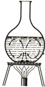
Abb. 90. Wärmeströmung in einer Kochflasche. In der Flasche entsteht eine in der Mitte aufsteigende, an der Glaswand absinkende Strömung. Sie wird durch Farbschlieren sichtbar gemacht.
