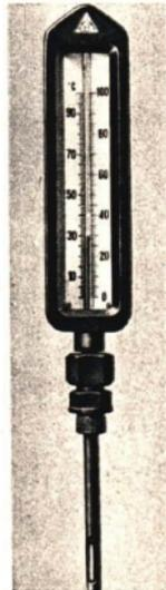
behälter des Thermometers gelangen kann. Die sehr sorgfältig ausgeführte Skala befindet sich in einem flachen Gehäuse, das ein bequemes Ablesen gestattet. Der Meßbereich richtet sich nach der Höhe der zu messenden Temperatur. Technische Thermometer werden zum Messen von Temperaturen von  $-20^{\circ}\text{C}$  bis zu  $500^{\circ}\text{C}$  hergestellt.
