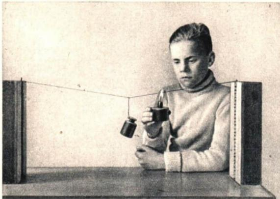
Abb. 79. Beim Erwärmen des Drahtes durch eine Flamme dehnt er sich aus; das Gewichtstück senkt sich.
