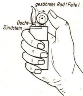
Abb. 68. Feuerzeug. Die Benzindämpfe werden durch glühende, vom Zündstein abgerissene Metallteilchen entzündet.
