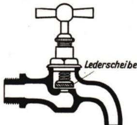
Abb. 48. Wasserhahn (Ventilhahn)
