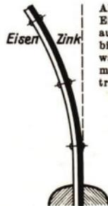
Abb. 83. Ein Bimetallstreifen aus Eisen und Zink biegt sich beim Erwärmen (die Krümmung ist stark übertrieben gezeichnet).
