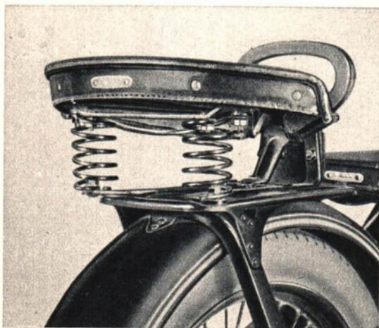
Abb. 34. Schraubenfeder (Druckfeder) am Soziussitz eines Motorrades
