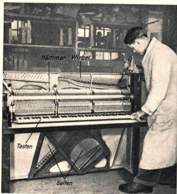
Abb. 117. Klavierstimmer bei der Arbeit. Vor den kreuzweise ausgespannten Saiten sind die Tasten und das Hammerwerk sichtbar.
