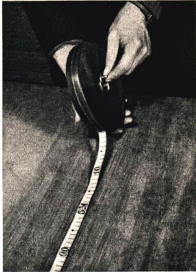
Abb. 14. Technisches Bandmaß. Das Bandmaß befindet sich bei Nichtgebrauch in einer Lederkapsel und wird mit Hilfe einer Kurbel aufgewickelt.
