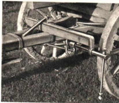
Abb. 52/4. Bremsspindel am Ackerwagen
