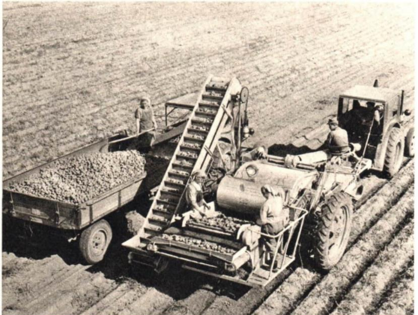
Arbeitskräfte erforderlich. Die sauberen Knollen werden mit Hilfe eines Förderbandes auf einen neben der Vollerntemaschine fahrenden Wagen geladen.
