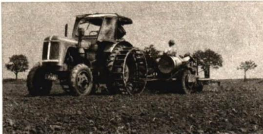
Abb. 41/1. Radschlepper „Pionier“ mit Giterrädern
