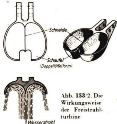
Abb. 153/2. Die Wirkungsweise der Freistrahlturbine
