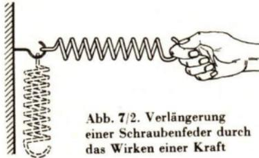
Abb. 7/2. Verlängerung einer Schraubenfeder durch das Wirken einer Kraft
