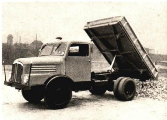
Abb. 99/2. Lastkraftwagen „Sachsenring S 4000“ mit Dreiachsenkipper
