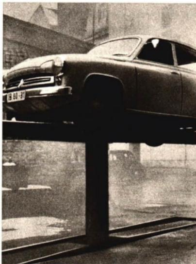
Abb. 94/1. Hydraulischer Wagenheber
