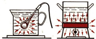
70/1 Wärmeabgabe an einem Tauchsieder und an einer Kochplatte.
