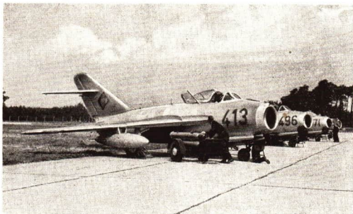
83/2 Die Außenhaut moderner Flugzeuge besteht aus eloxierten Aluminiumblechen
