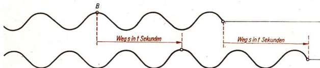
144/3 Bestimmung der Ausbreitungsgeschwindigkeit einer Welle
