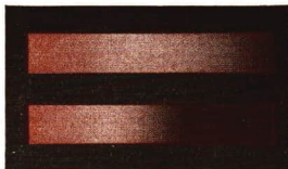
211/1 Emissionsspektren einer Glühlampe 1 bei großer Stromstärke, 2 bei kleiner Stromstärke
