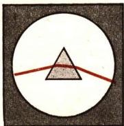
184/2 Bei symmetrischem Durchgang des Lichtes durch ein optisches Prisma ist die Gesamtablenkung am kleinsten
