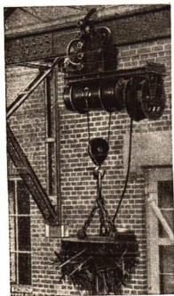
Abb. 55/1. Elektrisches Hebezeug. Der Motor ist im Gehäuse der Laufkatze untergebracht.
