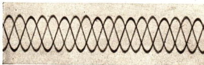
Abb. 68/1. Ein mit einem Dreifach-Schleifenzosillographen aufgenommenes Oszillogramm der Phasenverschiebung dreier Wechselströme
