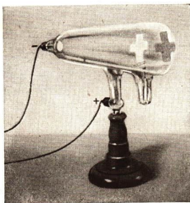
Abb. 129/1. Kathodenstrahlrohr mit umklappbarem Aluminiumkreuz. Die Kathodenstrahlen werfen einen scharf begrenzten Schatten des Kreuzes auf die gegenüberliegende Glaswand.
