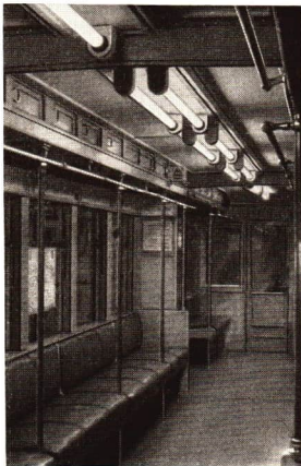
Abb. 127/1. Ein mit Leuchtstofflampen beleuchteter U-Bahn-Wagen
