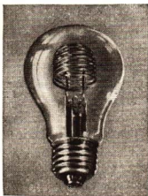
Abb. 125/1. Glimmlampe mit zwei Spiraldrahtelektroden, Leistungsverbrauch etwa 3 Watt
