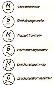
Abb. 50/3. Schaltkurzzeichen von Motoren und Generatoren
