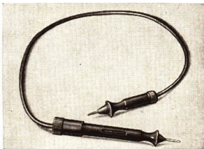
Abb. 125/2. Die Glimmlampe als Spannungsprüfer
