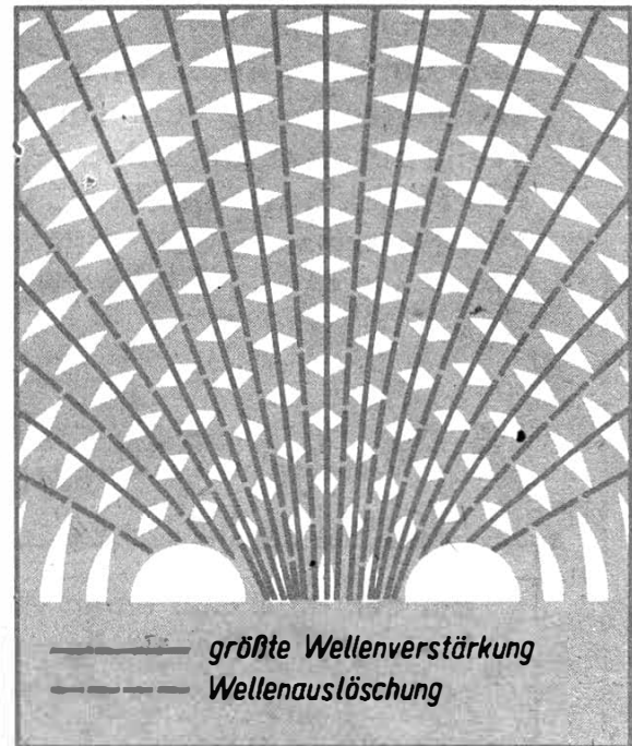
Bild 200/1 Interferenz von zwei Wasserwellen gleicher Frequenz und gleicher Amplitude
