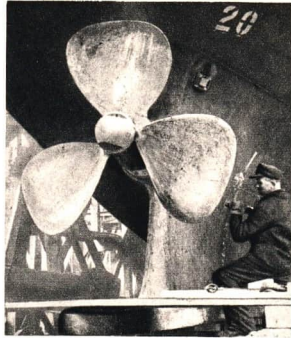
Abb. 177. Schiffsschraube am Heck eines auf der Volkswerft in Stralsund erbauten Fischloggers. Durchmesser der Schraubenfläche 1,5 m
