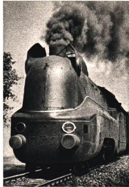
Abb. 110. „Stromlinienlokomotive“ Sie ist zur Herabsetzung des Luftwiderstandes mit einem Blechmantel verkleidet.
