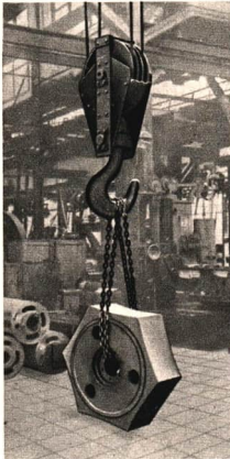
Abb. 154. Unterer Block eines großen Flaschenzuges mit Traghaken und angehängter Last
