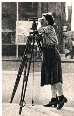
Abb. 87. Lot an einem Feldmeßgerät. Durch das Lot wird auf dem Erdboden der Fußpunkt festgelegt, über dem sich das Meßgerät befindet.
