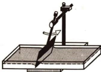
12/2 Pendelschwinger mit Dämpfungsscheibe
